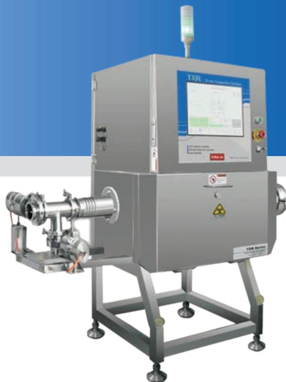
Этот тип рентгена легко интегрируется в существующую герметичную систему трубопроводов. Данная система контроля подходит для жидких продуктов под давлением и полужидких продуктов в трубе, таких как соус, кетчуп, майонез и т.д. Выбраковочный клапан автоматически отводит часть потока продукции с инородным включением в другой канал.
