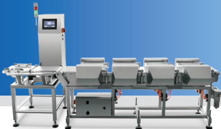
Используется для взвешивания и сортировки по весу рыбы и морепродуктов, птицы, замороженных продуктов и др.
