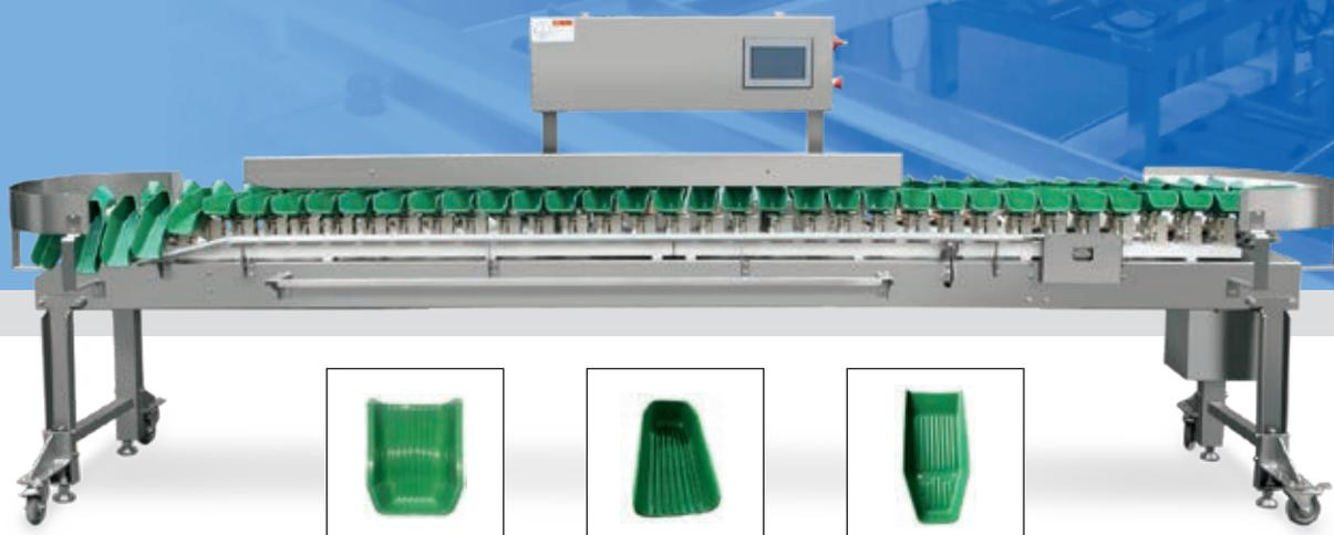
Оборудование для динамической сортировки по весу предназначено для автоматической сортировки продуктов с высокой скоростью и высокой точностью в соответствии с их весом согласно требований пользователя. Измерение общего веса и количества - опционально.
