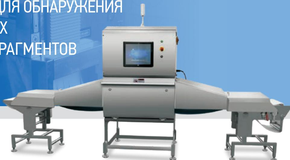
Подходит для поточного нахождения остаточных фрагментов костей при переработке мяса. На данной машине не устанавливаются защитные освинцованные шторы, чтобы обеспечить гигиеническую чистоту. Для защиты персонала от излучения используются длинные защитные кожуха, а также зона детектирования находится выше уровня входа и выхода продукции.
