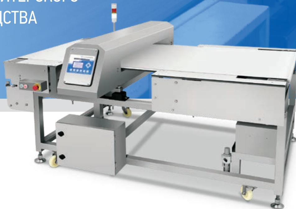
Благодаря уникальной конструкции системы отбраковки с пневматической системой с втягивающимся краем конвейера, данное оборудование широко используется на производствах печеня и конфет. Самое распространенное место установки после охлаждающего тоннеля. Минимальный диаметр роликов позволяет работать с продуктами минимальной длины.
