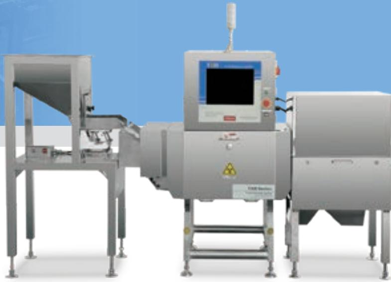
Широко используется для проверки сыпучих гранулированных продуктов, например орехи, семечки, крупы, гречка, рис, кукуруза, изюм, замороженные овощи и т. д., россыпью на конвейере до их упаковки.
