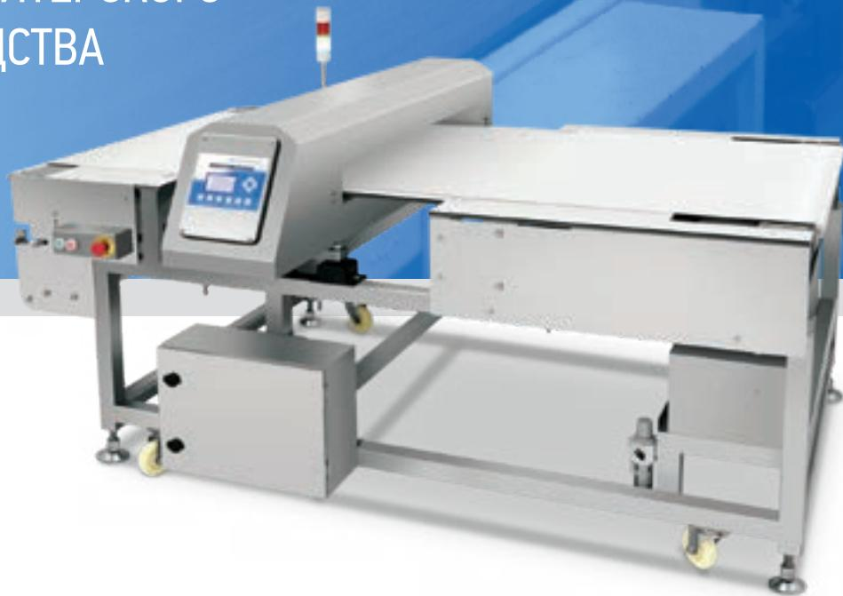
Благодаря уникальной конструкции системы отбраковки с пневматической системой с втягивающимся краем конвейера, данное оборудование широко используется на производствах печенья и конфет. Самое распространенное место установки после охлаждающего тоннеля. Минимальный диаметр роликов позволяет работать с продуктами минимальной длины.
