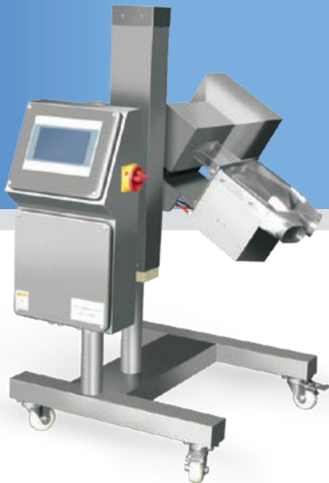
Используется для проверки таблеток и капсул. Благодаря тому, что апертура МД небольшая, а проверяемый продукт не имеет больших размеров, то достигается высокая чувствительность и стабильность обнаружения черных металлов (Fe), цветных и металлов (NFe) и нержавеющей стали (SS). Этот тип машин подходит для установки после таблеточного пресса, машины для наполнения капсул и обеспылевателя.
