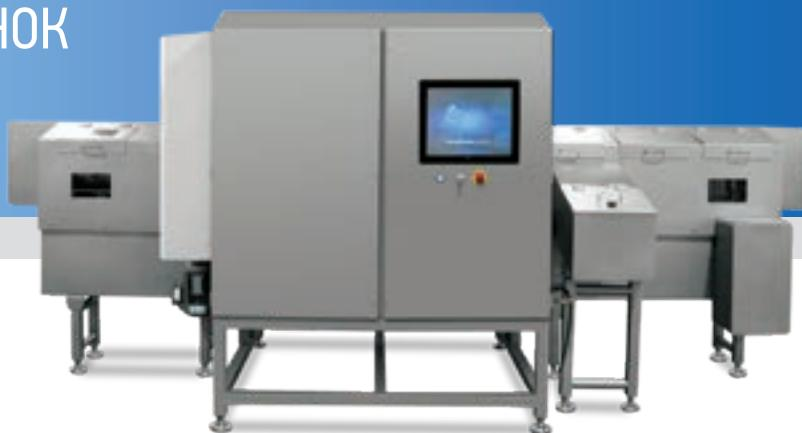
Система рентгеновского контроля с двумя лучами и программным обеспечением, специально разработанным для инспекции объектов во всем пространстве бутылок, стеклянных и жестяных банок.
